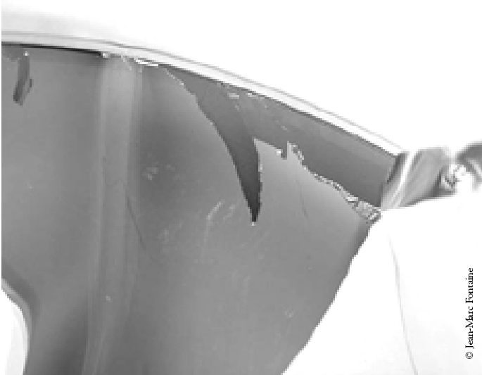
CDR : couche sensible d'enregistrement montée sous le film métallique. CDR: dye layer shown under metallic layer.
