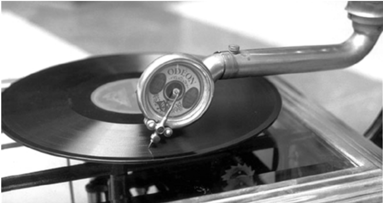
Le poids exercé par la pointe sur l'appareil d'origine use le disque très sévèrement. Severe disc wear due to the weight of the stylus fitted on the original player
